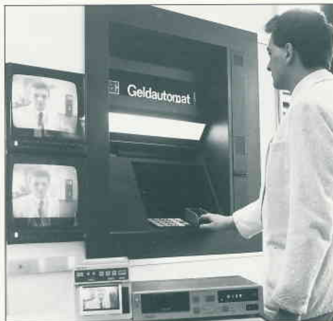
Die auf dem Foto erkennbare Produkt-Peripherie (Monitore, Drucker und Recorder) verschwindet in der Praxis, für den Kunden unsichtbar, hinter dem Bedienungs-Board.
